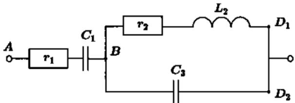
Пусть  $r_1 = 5 \text{ Ом}$ ,  $r_{c_1} = 15 \text{ Ом}$ ,  $r_2 = 12 \text{ Ом}$ ,  $r_{l_2} = 16 \text{ Ом}$ ,  $r_{c_3} = 10 \text{ Ом}$ . Необходимо найти сопротивление всей цепи.
